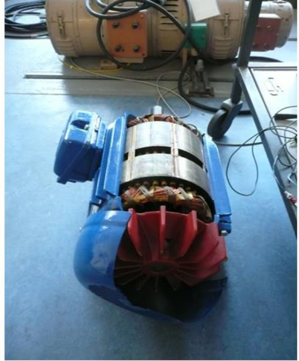
Obr. 2.1. Stroj pro konstrukční měření a měřený motor
