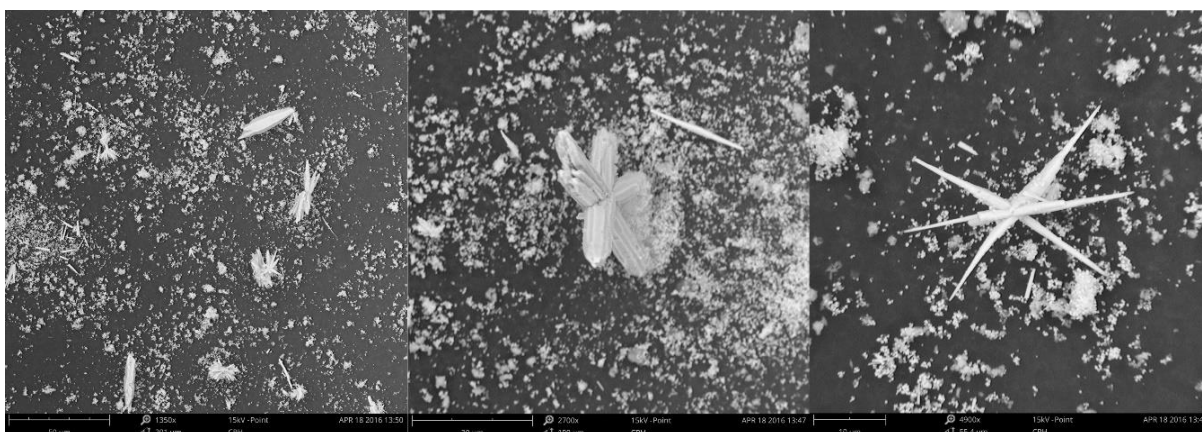
Obr. 23 Struktura vyrobeného nekalcinovaného vzorku s pH 7,5. Vlevo přibližného na 50 \mu\text{m} , uprostřed 30 \mu\text{m} a vpravo 10 \mu\text{m} .
