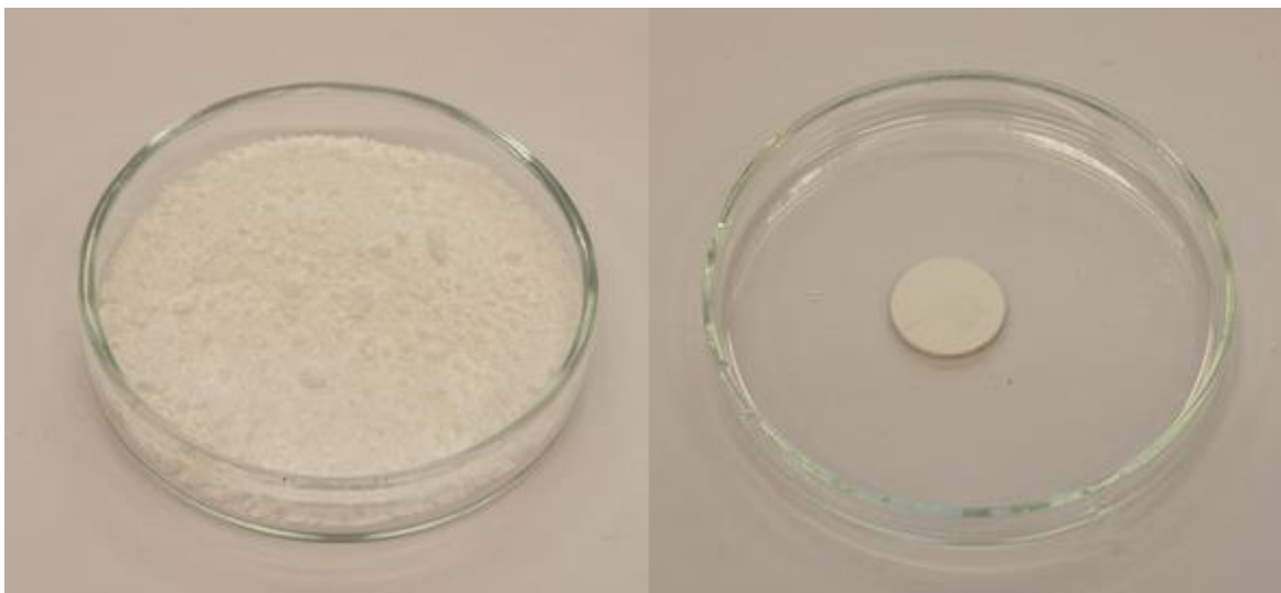
Obr. 21 Vlevo bílý prášek po vysušení, vpravo peleta připravená pro měření
