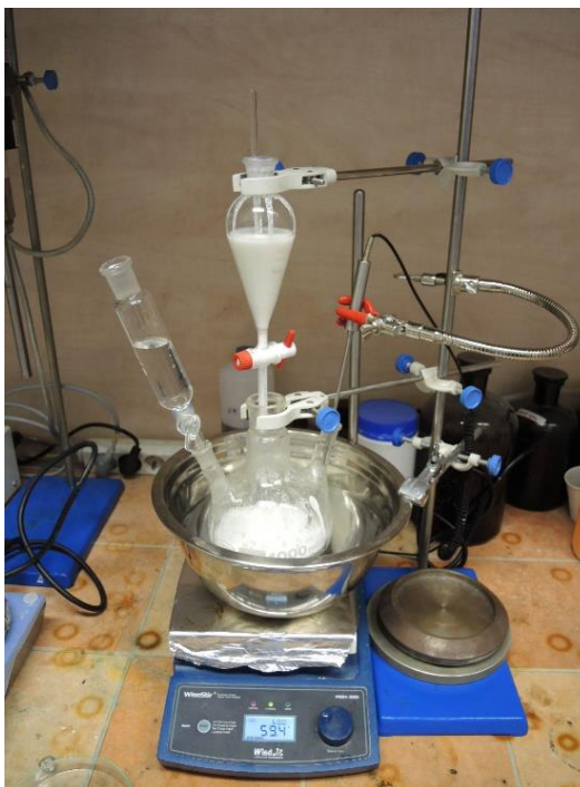
Obr. 20 Sestava pro precipitační metodu. V destilační baňce NaOH, zleva se přikapává roztok chloridů, uprostřed roztok butoxidu titaničitého a zprava teploměr.
