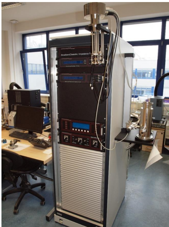
Obr. 22 Dielektrický spektroskop Novocontrol Alpha A s potřebným příslušenstvím
