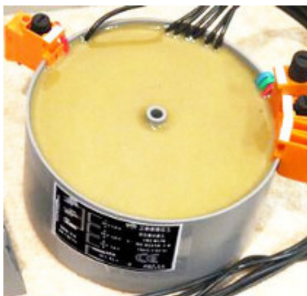
Obr. 11: Dvousložková polyuretanová zalévací hmota v praxi (převzato z [25])
