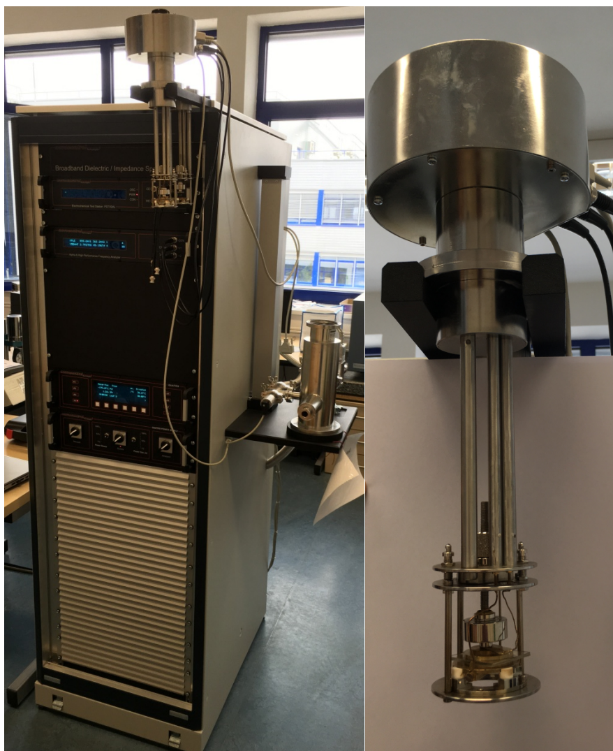
Obr. 21: Frekvenční analyzátor Alpha A (vlevo) a elektrodový systém ZGS (vpravo)
