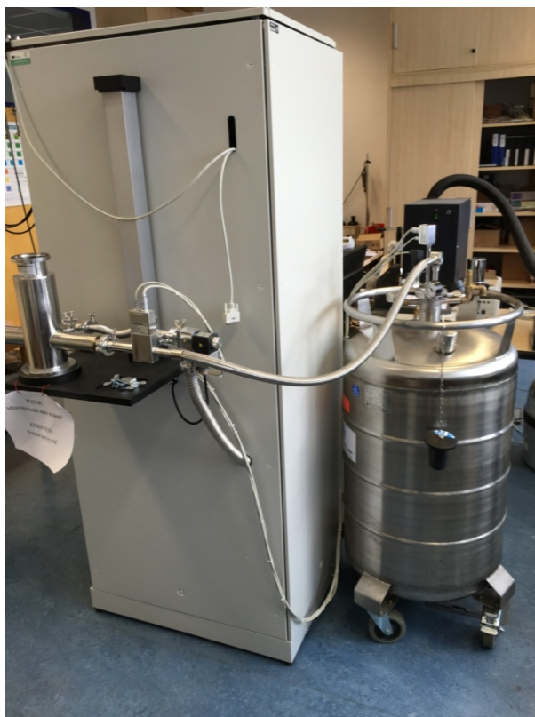
Obr. 22: Zadní strana frekvenčního analyzátoru Alpha A a kryosystem
