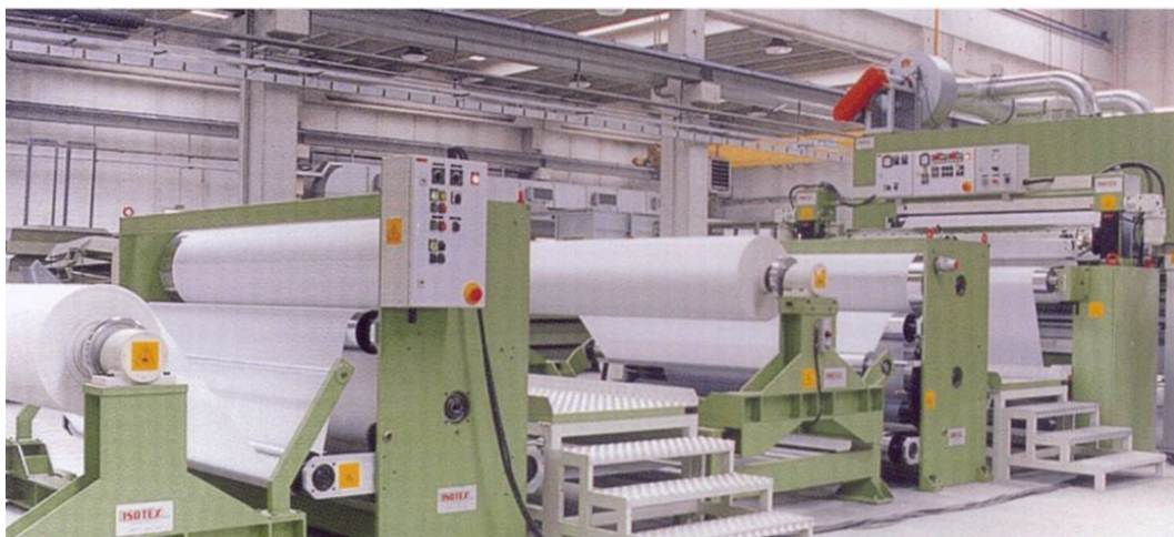
Obr. 6: Linka na výrobu fólií za pomoci válcování (převzato z [5] a upraveno)
