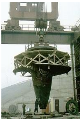
Obrázek č. 4: Oběžné kolo Kaplanovy turbíny, převzato z [5]
