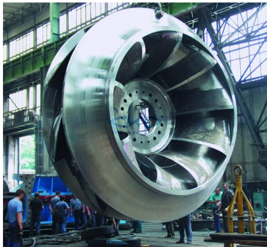
Obrázek č. 6: Oběžné kolo Francisovy turbíny, převzato z [7]
