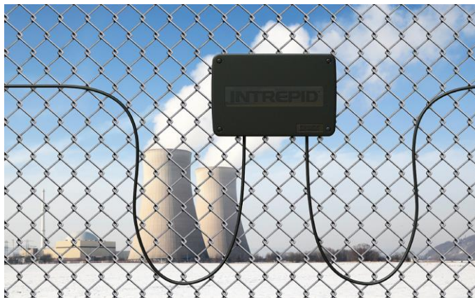
Obr. 8 Správná aplikace mikrofonického kabelu [Zdroj: 8]
