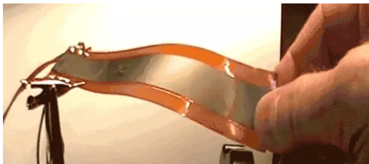
Obrázek 9: Páska s integrovanými cívkami [6]
