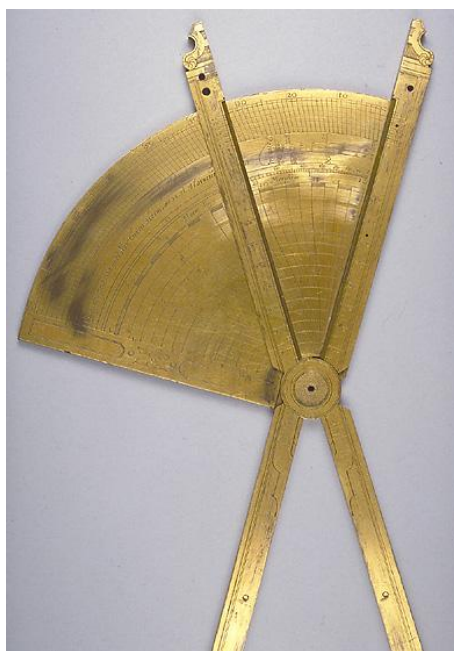
Obr. 7.26: Geodetické poměrové odpichovátko z 16. století
