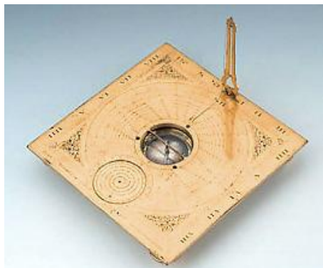
Obr. 7.25: Horizontální sluneční hodiny z 16. století
