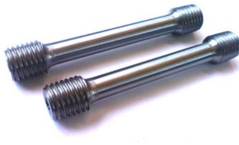
Obr. 72. Zkušební tyče pro zkoušku tahem
