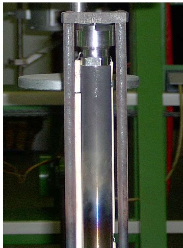
Obr. 136 Uspořádání zkoušky tečení - SPT vzorek
