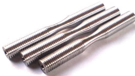
Obr. 97 Použité klasické zkušební tyče pro zkoušky únavy - aktivní část \varnothing 3mm
