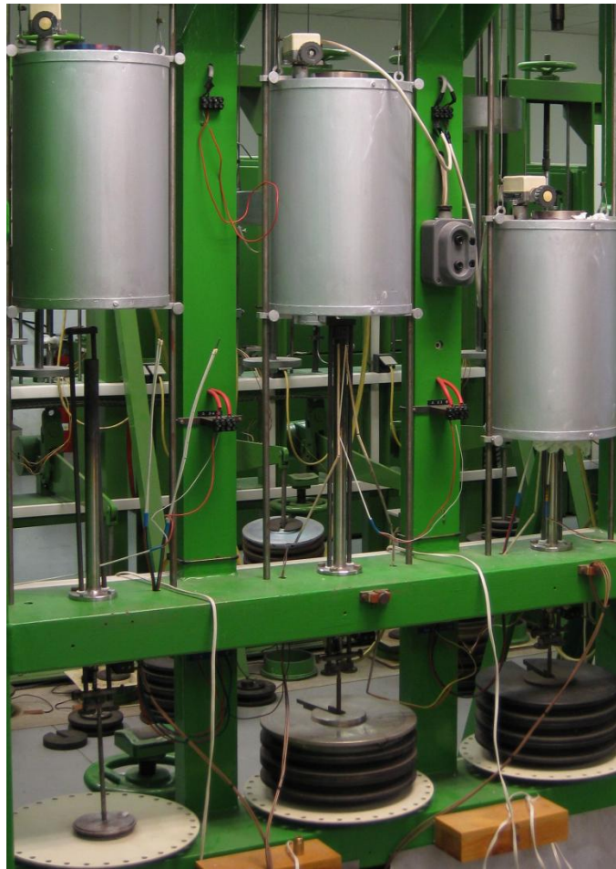
Obr. 132 Zařízení, speciálně upravené pro SPT creep testy
