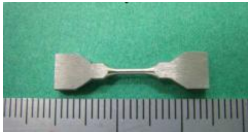
Obr. 122 Tvar zkušebního tělesa
