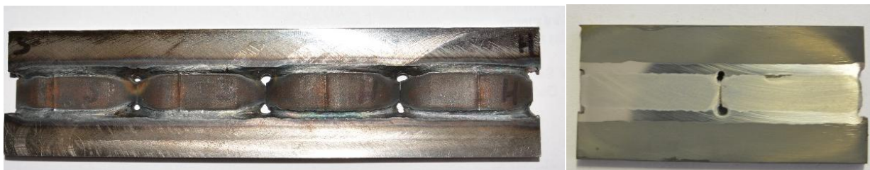
Obr. 34 Polotovar pro výrobu mini-Charpy těles, vlevo - po zavaření, vpravo – broušený na rozměr
