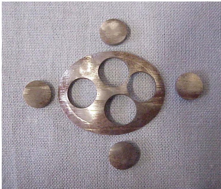
Obr. 32 Disky pro testy SPT odebrané ze zkušebního materiálu [33]
