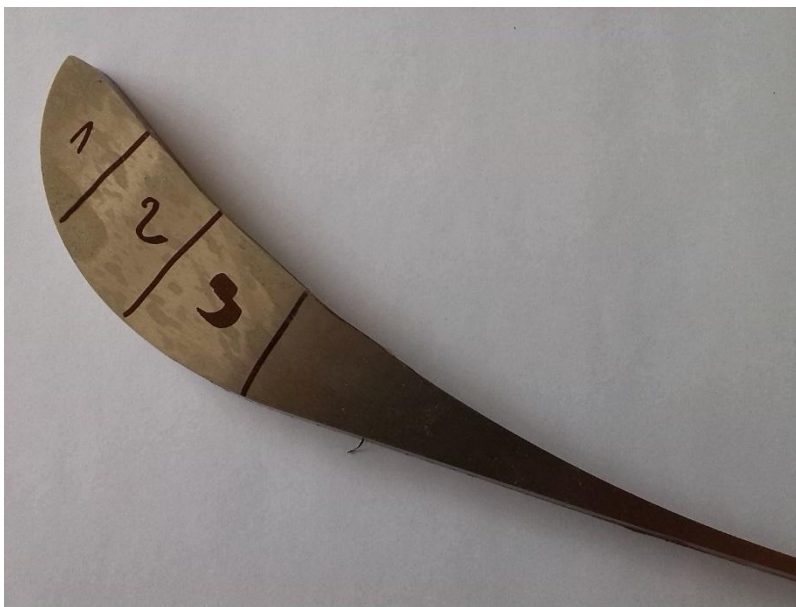
Obr. 115 Řez lopatkou s vyznačením míst pro hodnocení mikrostruktury
