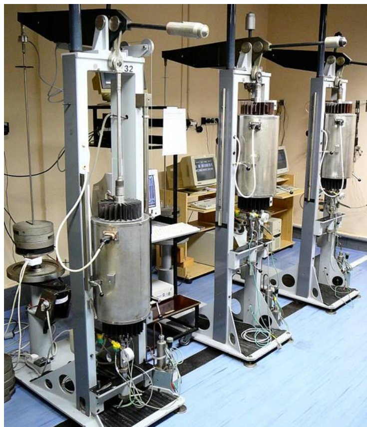
Obr. 26 Zařízení pro zkoušky tečení [28]
