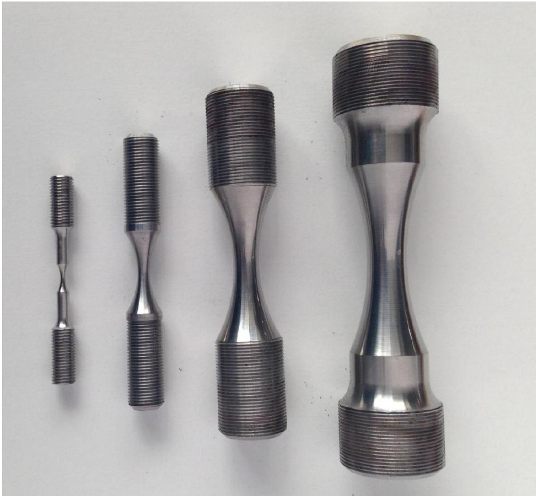
Obr. 125 Zkušební tělesa o průměru zleva 1,5, 4, 8, a 12mm
