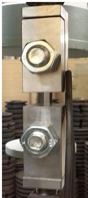
Obr. 137 Uspořádání zkoušky tečení - mini vzorek
