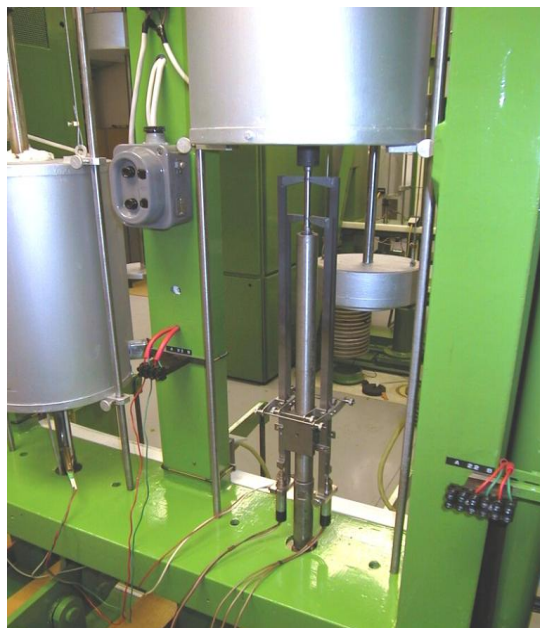
Obr. 135 Uspořádání zkoušky tečení - klasický vzorek
