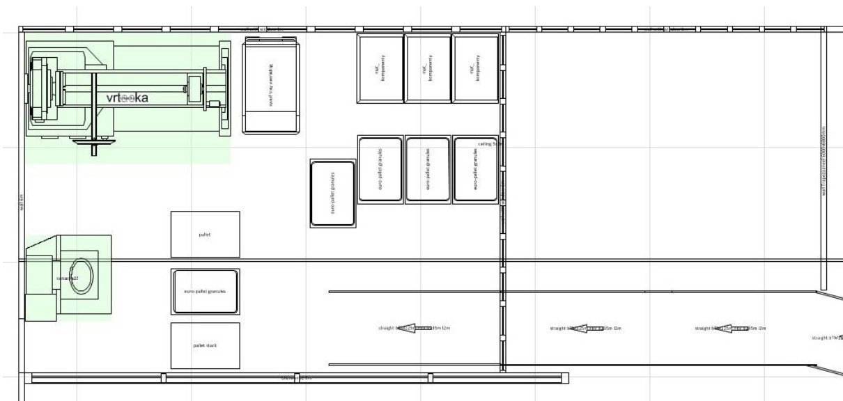
Obr. 4-5 Půdorys pracoviště pro výrobu produktů PROFIX
