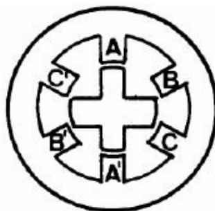
obr. 31- schéma třífázového krokového motoru s pasivním rotorem [33]
