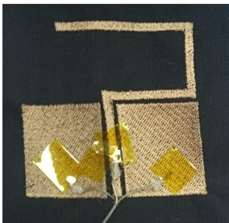
Obrázek 45 -Testovací vzorek flíčková anténa č.3 – typ C
