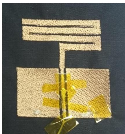
Obrázek 46 - Testovací vzorek flíčková anténa č.4 – typ meandr
