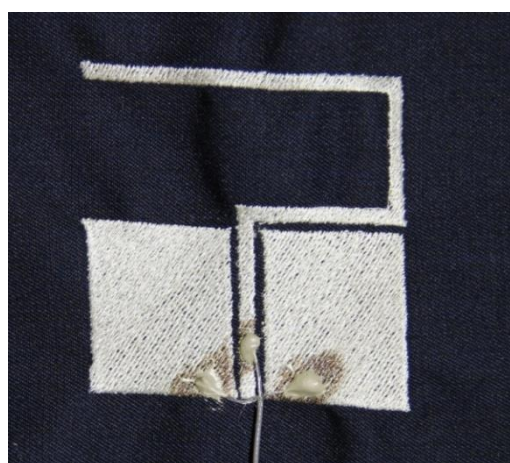
Obrázek 41 - Testovací vzorek flíčková anténa č.1 – typ C
