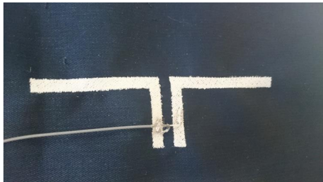
Obrázek 44 - Testovací vzorek dipól č.3
