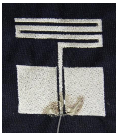
Obrázek 42 - Testovací vzorek flíčková anténa č.2 – typ meandr
