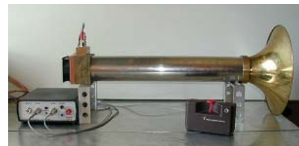
Fig. 10: Gerdien condenser[5] ( M=12,14 \text{ dm}^3 , v=3,75 \text{ ms}^{-1} , I_{leak}=0,3 \text{ pA @ } 150\text{V} )
