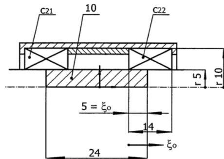
Fig. 3b: Arrangement of electromagnetic actuator  $A_2$ :
