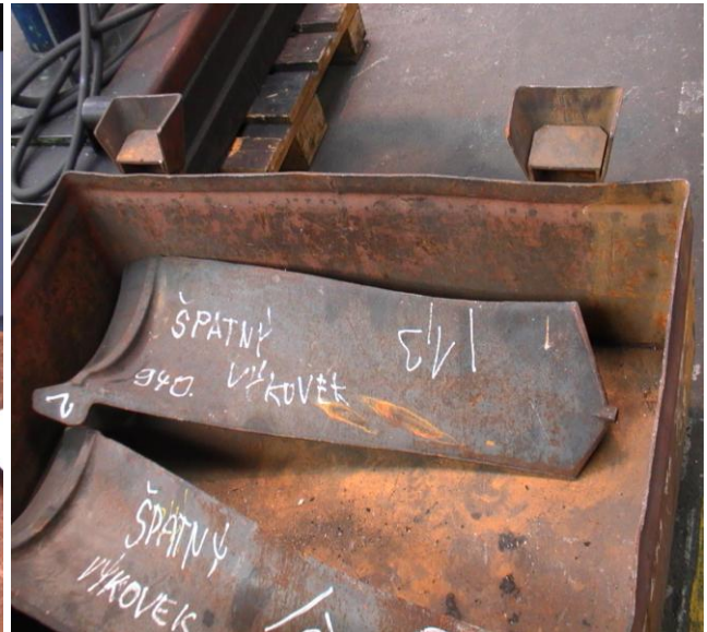
Obr. 28 Polotovar lopatky – výkovek [12]
