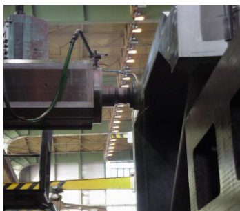
Obr. 25 Frézování nízkotlakého tělesa [12]
