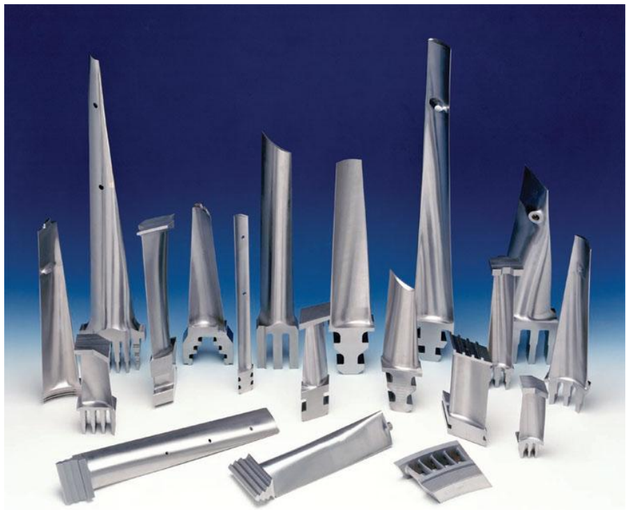
Obr. 6 Různé tvary oběžných lopatek a jejich závěsů [V]
