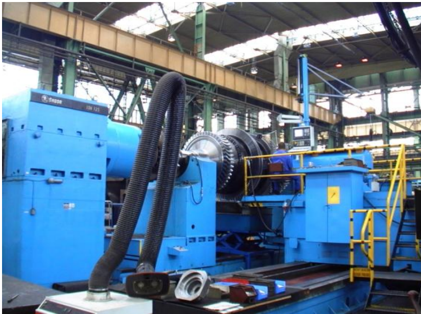
Obr. 45 NC svrtávací zařízení pro velké rotory [12]
