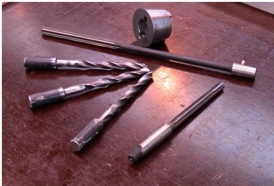
Obr. 47 Nástroje pro výrobu otvorů pro kolíky [12]
