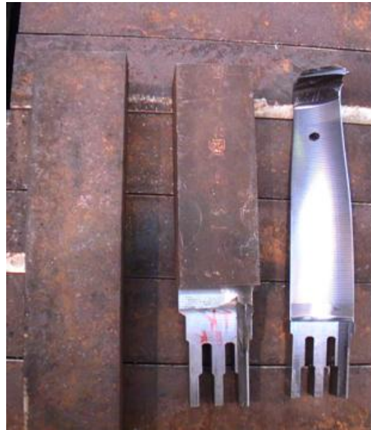
Obr. 30 Postup výroby oběžné lopatky [12]
