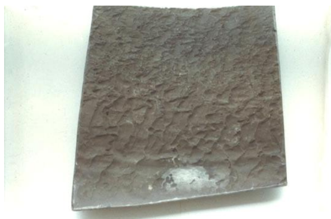
Obr. 12 Korozně erozivní poškození niklové slitiny [X]
