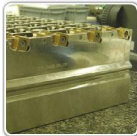
Obr. 36 Použití protahovacích trnů [XVI]
