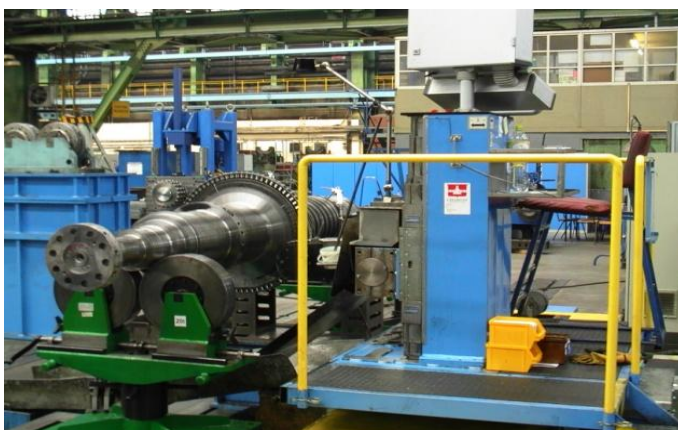
Obr. 43 NC svrtávací zařízení pro menší rotory [12]
