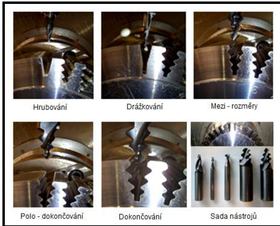
Obr. 32 Výroba drážky – společnost SECO [XVI]
