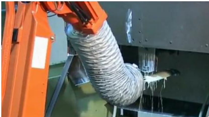
Obr. 40 Leštění oběžné lopatky robotem [XVIII]
