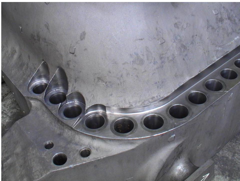
Obr. 37 Vrtané otvory v dělicí rovině skříně parní turbíny [12]
