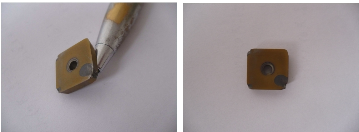
obr. 15: Použité břitové destičky SPKN na katedře KTO [44]
