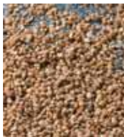
Obr. č.11: Médium HSC 1/300 od firmy OTEC präzisionsfinish GmbH [7]
