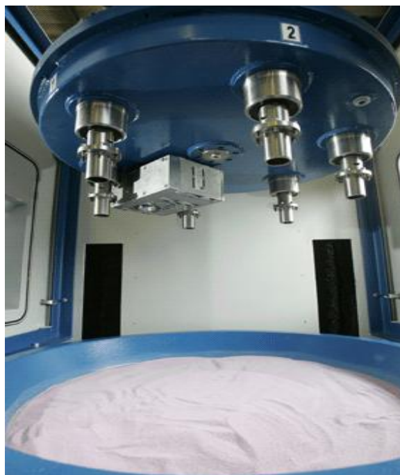
Obr. č.7: Vlečné omílací zařízení od firmy OTEC präzisionsfinish GmbH [7]
