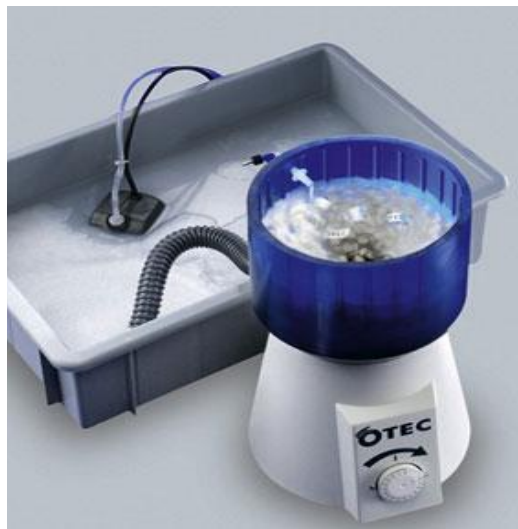
Obr. č.6: Zařízení pro mokré omílání s průměrem mísy 220 mm od firmy OTEC präzisionsfinish GmbH [7]
