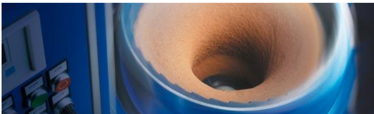
Obr. č.5: Odstředivé omílací zařízení v chodu od firmy OTEC präzisionsfinish GmbH [7]
