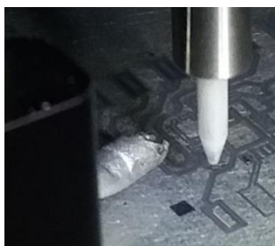
Obrázek I. Depozice materiálu pomocí technologie Aerosol Jet ®
