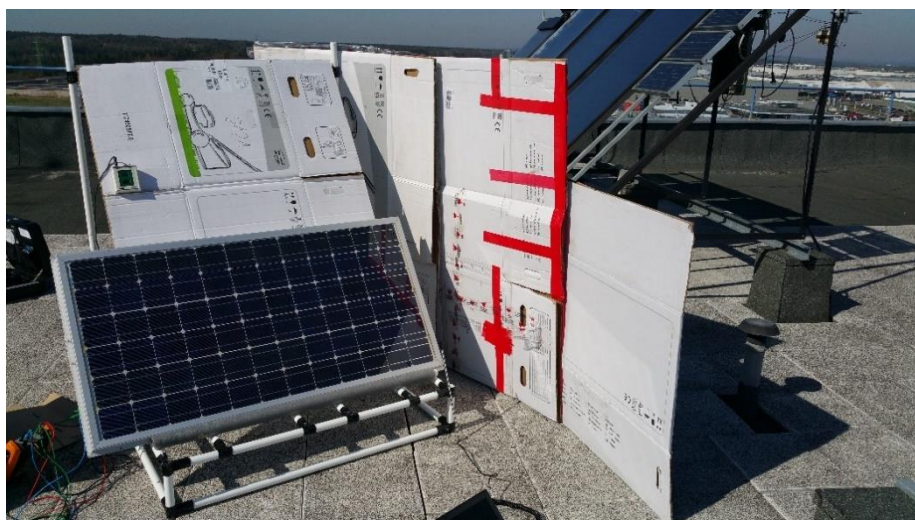
Obr. 2.6 Měření ohřevu FV panelu Solartec SI 72-110 / 24 110WP s použitím stínících kartonových ploch
