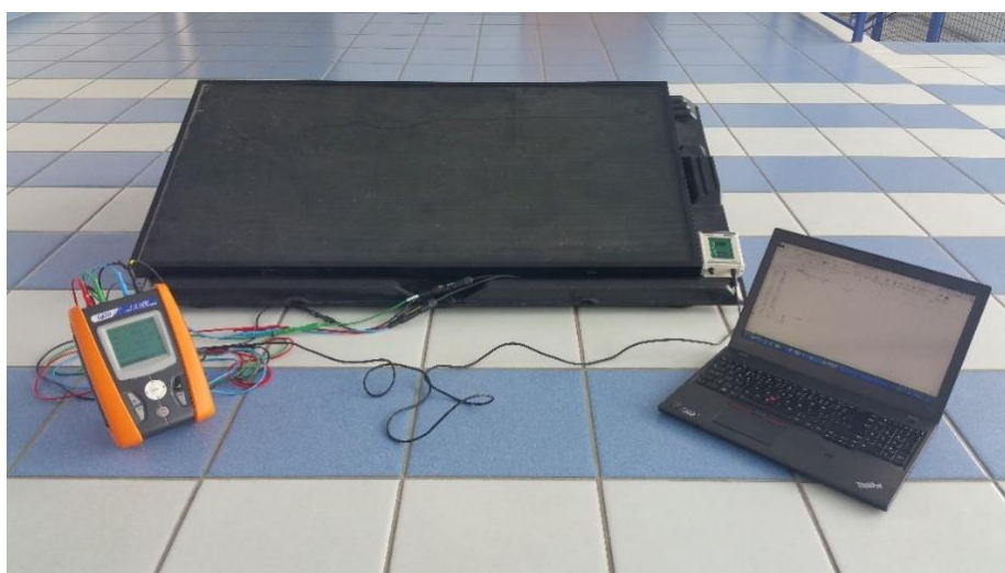
Obr. 2.7 Měření ochlazování FV panelu Q.Cells SL1-80F uvnitř budovy ZČU FEL
