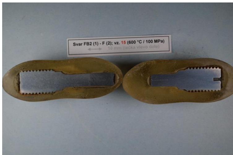
Obr. 37 - Vzorek 15 po standardních creepových testech s porušením v oblasti TOO oceli COST F
