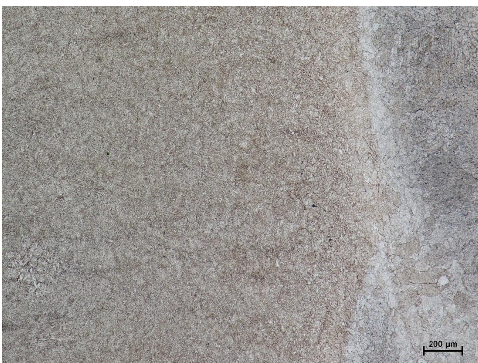
Obr. 60 - TOO u linie stavení oceli COST F
