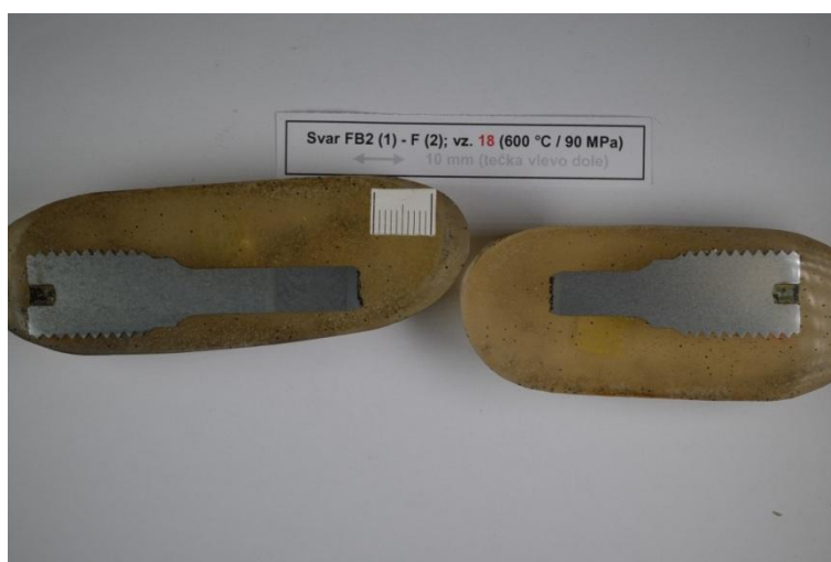
Obr. 38 - Vzorek 18 po standardních creepových testech s porušením v oblasti TOO oceli COST F
