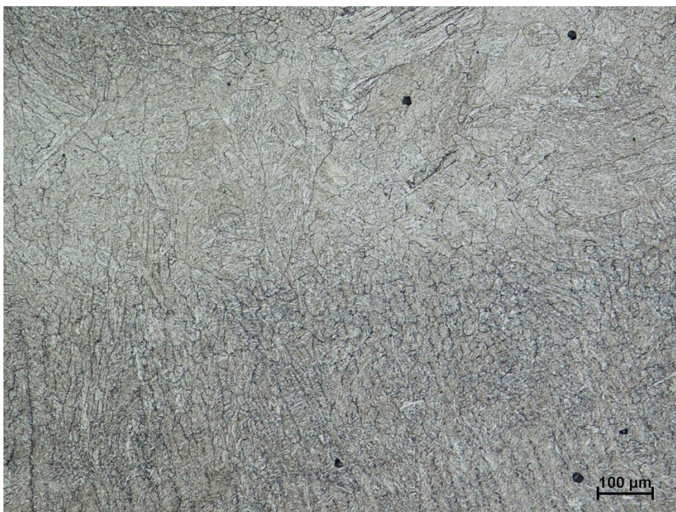
Obr. 62 - Svarový kov s výskytem kavitačního porušení
