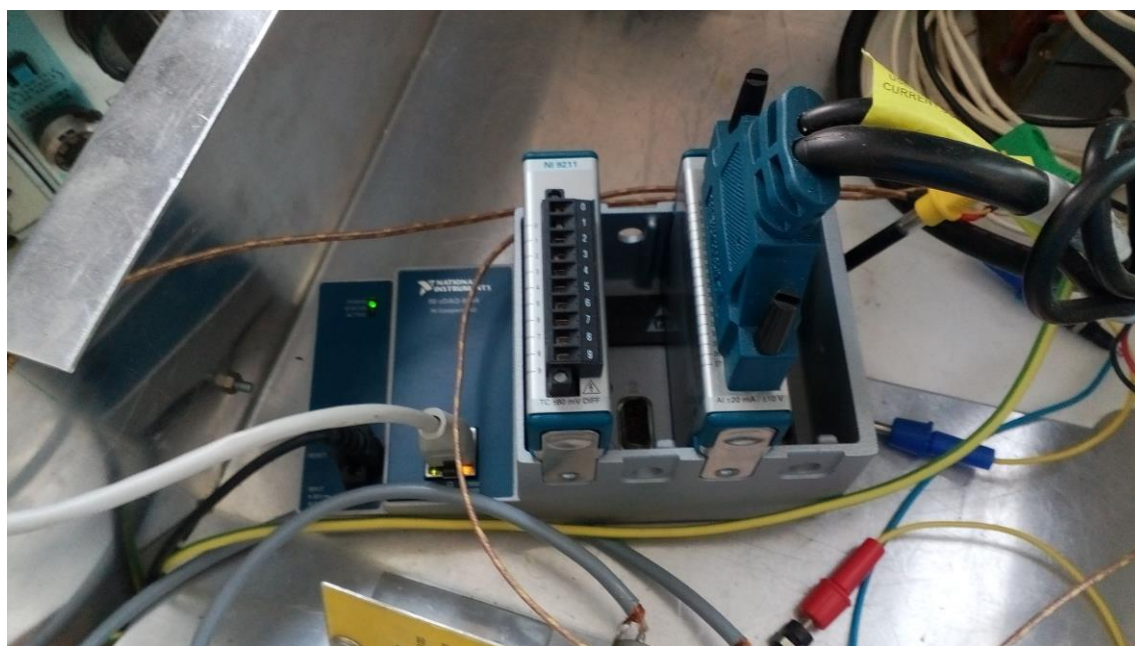
obr. 82: měřicí systém Compact DAQ – chasis cDAQ-9184 s dvěma I/O moduly
