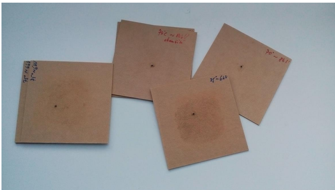
obr. 45: vzorky transformátorové lepenky 100 x 100 x 1 mm
