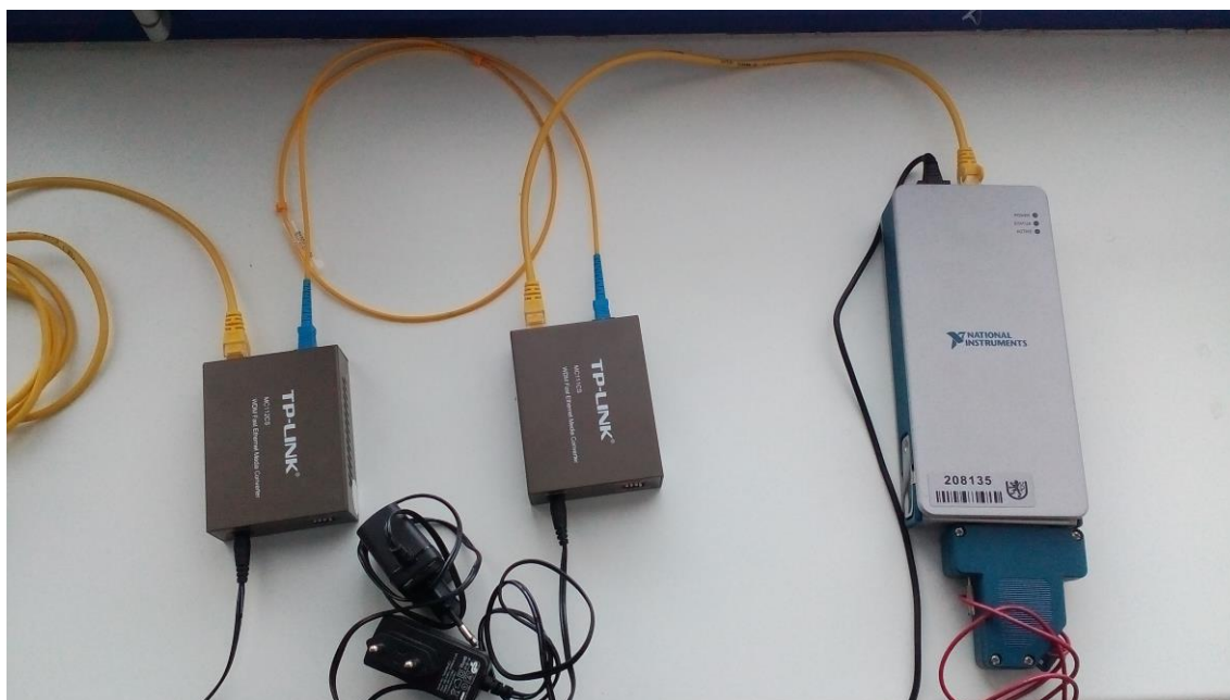
obr. 61: galvanické oddělení ethernetového přenosu pomocí optických převodníků
