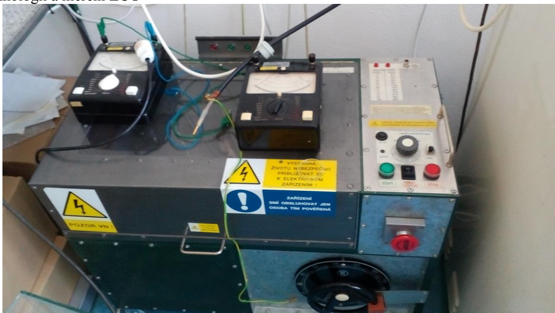
obr. 84: přístroj pro expozici vzorků elektroizolačních materiálů elektrickému napětí v rozsahu 0-12 kV.
