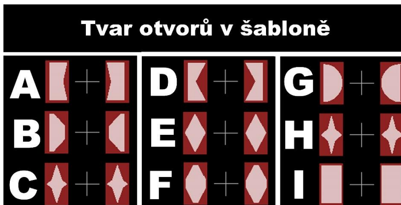
Obrázek 54: Navržené tvary otvorů v šabloně pro první část čtvrtého experimentu.
