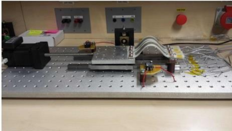
Obrázek 51: Zařízení pro mechanické namáhání flexibilního substrátu ohybem (tzv. bend test)
