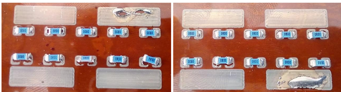
Obrázek 97: Vzorky po přetavení a odtržení součástek; 1 vrstva (vlevo), 2 vrstvy (vpravo).
