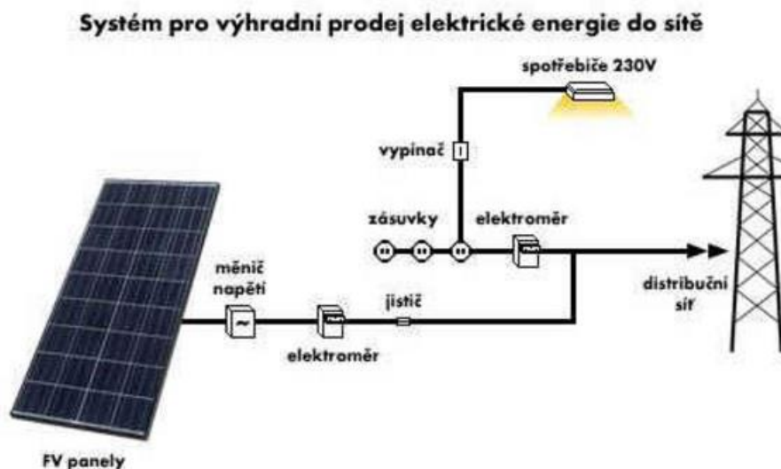
Obr. 11 Schéma systému pro výhradní prodej elektrické energie do sítě [20]
