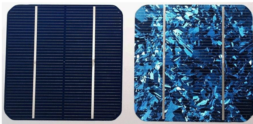
Obr. 5 Vlevo monokrystalický a vpravo polykrystalický fotovoltaický článek [13]
