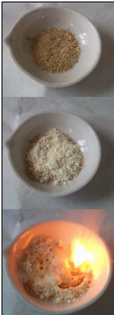
Obrázek 14 Piliny s peroxidem sodným. Vzplanutí pilin
