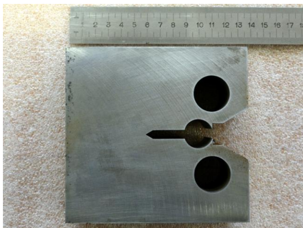
Obr. 26 – Zkušební vzorek pro zkoušku lomové houževnatosti typu 2T-CT
