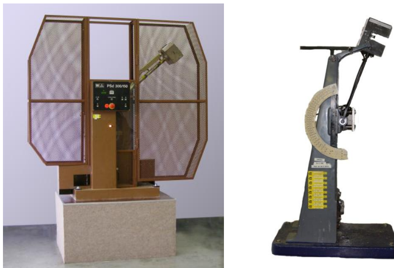
Obr. 34 – Charpy kladivo WPM PSd – 300 J (vlevo) a Charpy kladivo s počáteční energií 15 J (vpravo)
