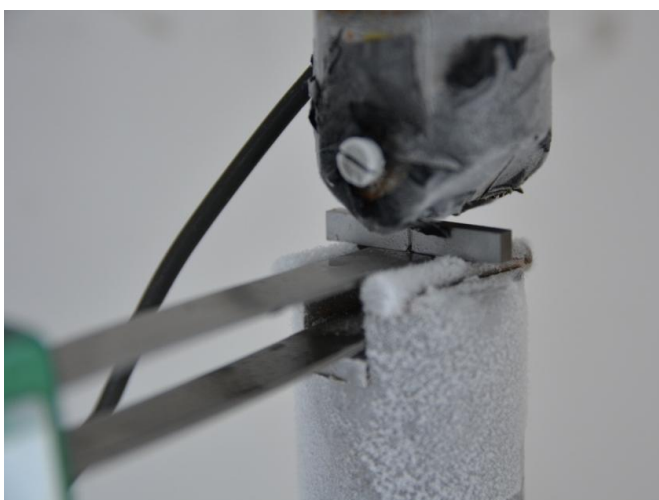
Obr. 53 – Uložení vzorku PKLST a COD snímače
