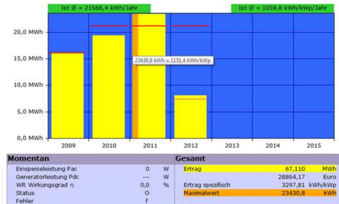
Obr. 3.10: Výkon vyrobený v každém roce od vzniku elektrárny
