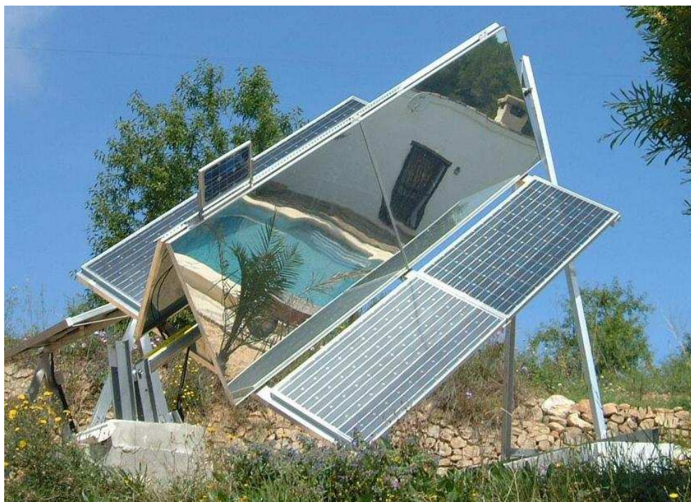
Obr. 4.: Konstrukce typu TRAXLE™ s hřebenovým koncentrátorem a automaticky s pohyblivým stojanem
