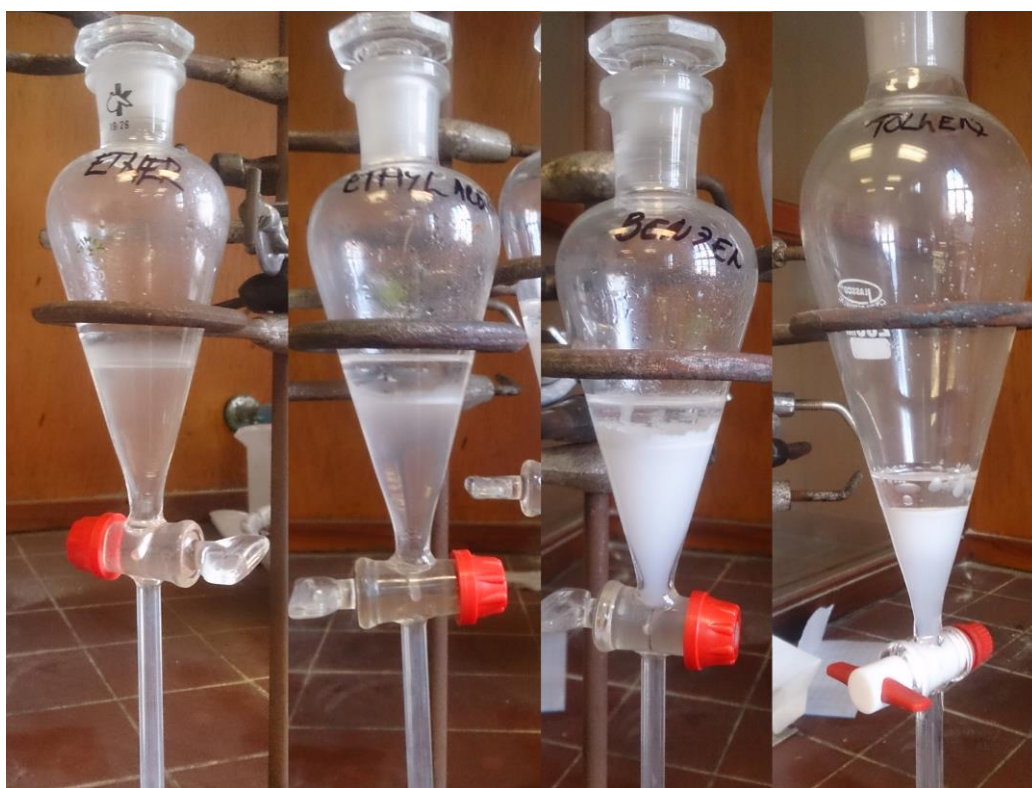
Obrázek č. 8: Rozdělování vodní a organické fáze u (řazeno zleva) etheru, ethyl acetátu, benzenu a toluenu.
