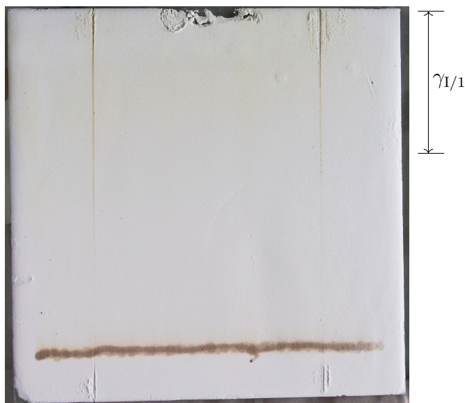
Obr. 2.15: Chromatogram v preparativním provedení TLC k separaci \gamma -apoallobetulinu. \gamma_{I/1} značí zónu, kterou jsem z chromatografu sňal a dále zpracovával.
