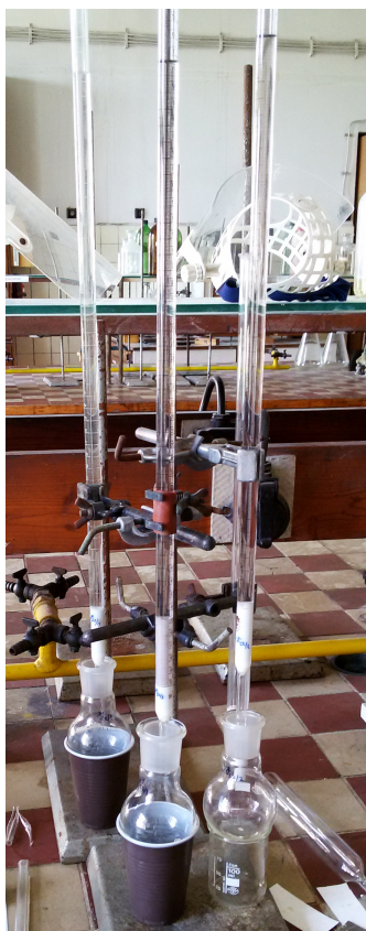
Obr. 2.20: Chromatografické trubice naplněné sorbenty ze zón \gamma_{1/2/1} , \gamma_{1/2/2} , \gamma_{1/2/3} při eluci obsažených látek do odvážených baněk ethyl-acetátem.
