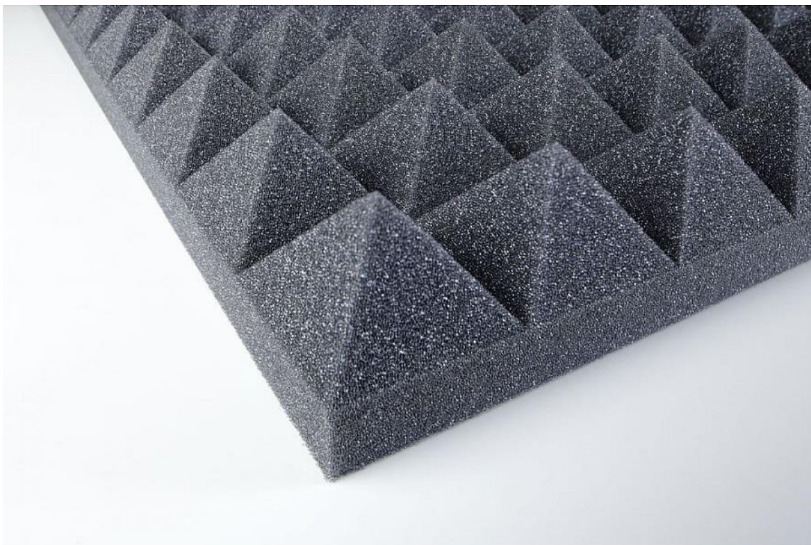
Obr. 3. 1 Polyuretanová pěna ve tvaru jehlanů. (překresleno z [16])
