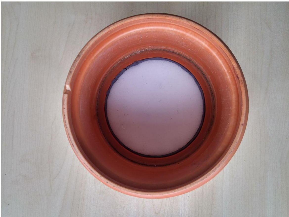
Obr. 7. 8 Umístění měřeného vzorku do držáku vzorku.
