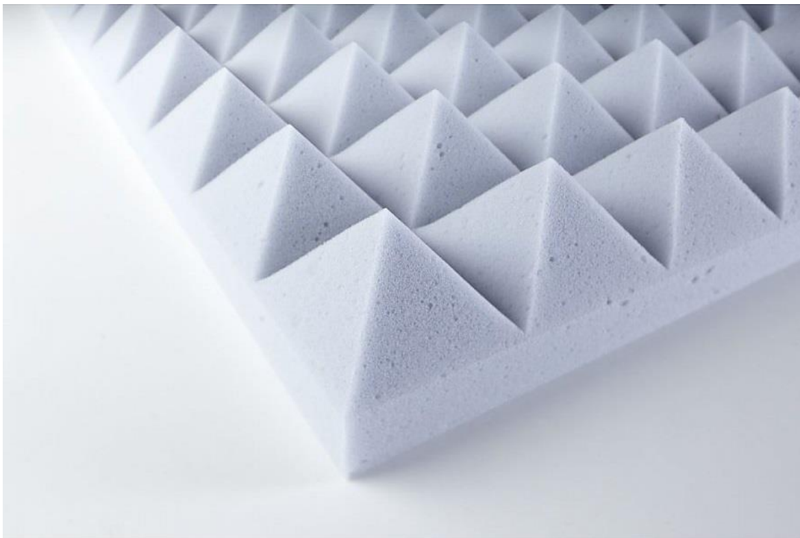
Obr. 3. 2 Melaminová pěna ve tvaru jehlanů. (překresleno z [19])
