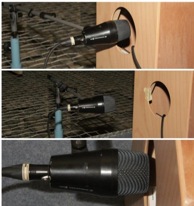
Obr. 14.: snímání pomocí kondenzátorového mikrofonu e902 na třech různých pozicích.
