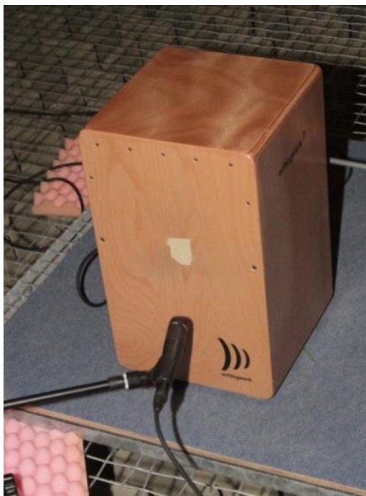
Obr. 13.: snímání pomocí mikrofonu SM57.
