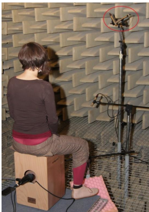
Obr. 16.: snímání pomocí dvou kondenzátorových tužek TN5.
