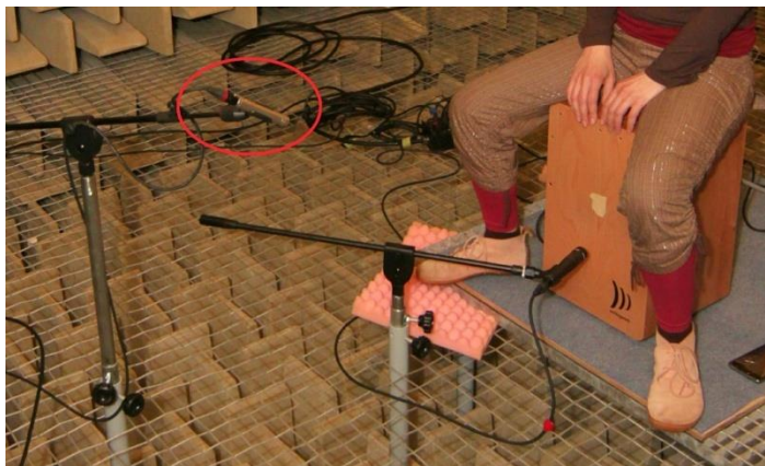
Obr. 15.: snímání pomocí jedné kondenzátorové tužky TN5.
