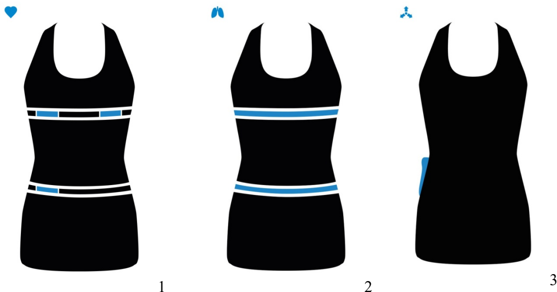
Obr. 6.1 Hexoskin smart shirts, umístění senzorů (převzato z [40]).
