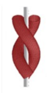
Obr. 4.2 Kovem obalená příze (převzato z [22]).
