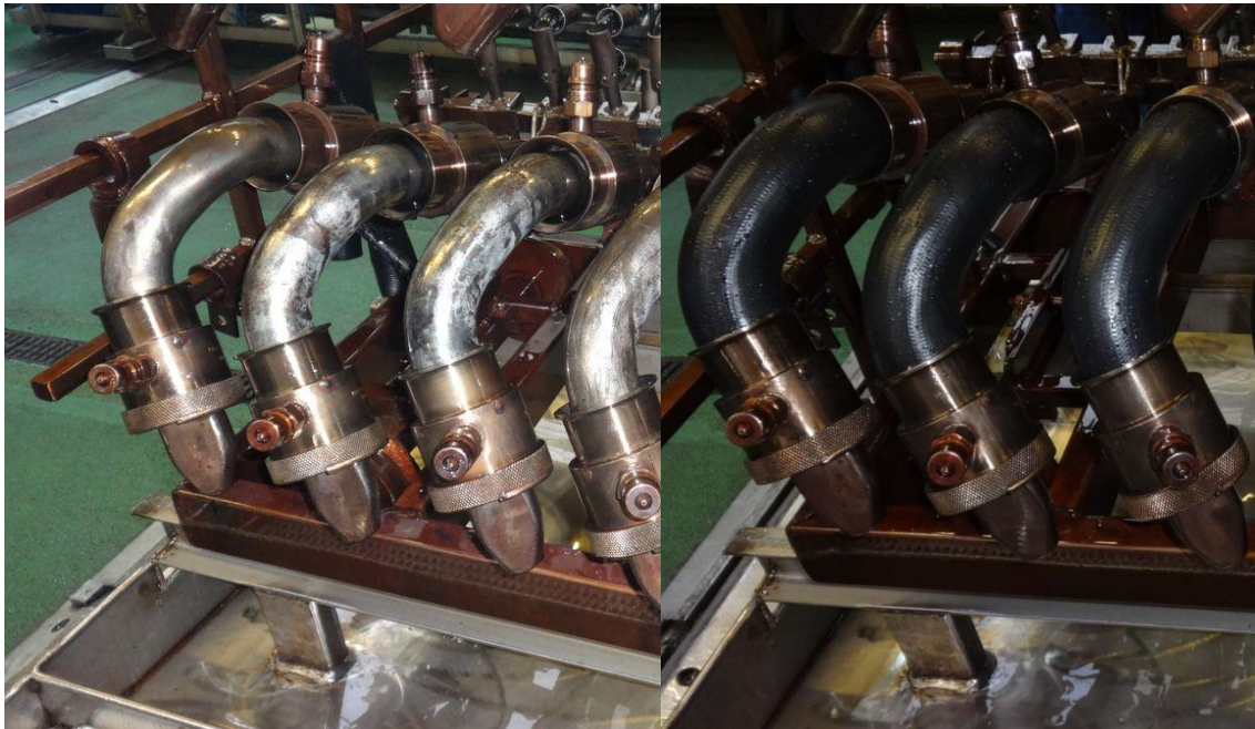
Obr. 12 Vulkanizační trny bez a s navlečeným polotovarem
