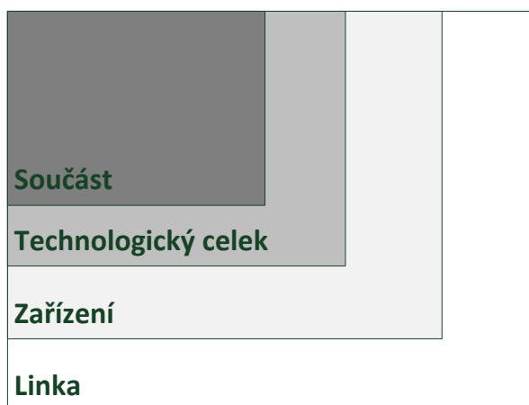
Obrázek 4-18: Hierarchické členění strojů a zařízení, [zdroj autor]
