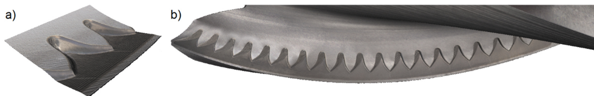
Obrázek 5-3 Ukázka kompletního skenu jednoho břitu upraveného segmentovými utvařeči třísek: a) detail b) celek
