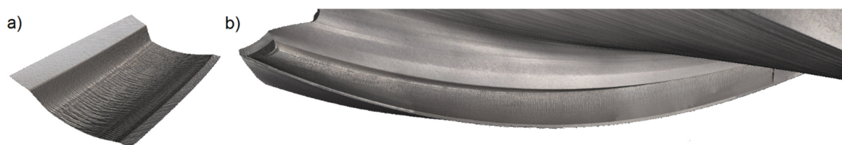
Obrázek 5-4 Ukázka kompletního skenu jednoho břitu upraveného plynulým utvařečem třísek: a) detail b) celek
