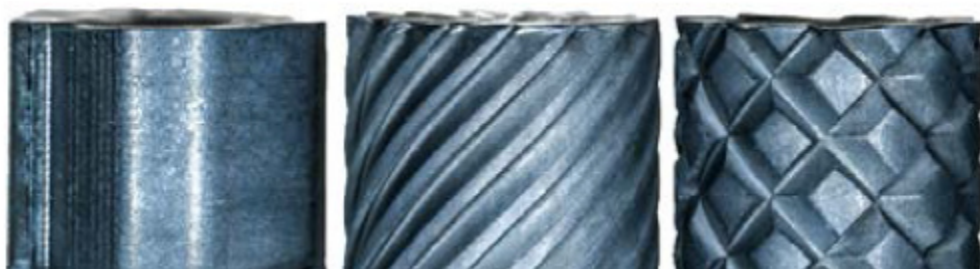
Obrázek 6-5 Ukázky tří navržených mikronástrojů z PCD [93]
