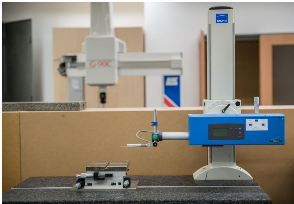
Obrázek 1: Celkový pohled na drsnoměr HOMMEL-ETAMIC T-8000
