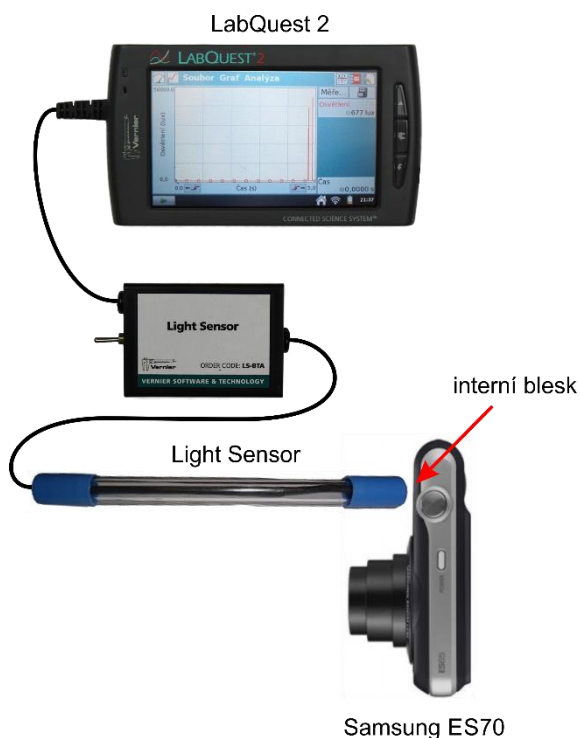
Obr. 7.1.1: Schéma zapojení pro záznam fotoblesku
