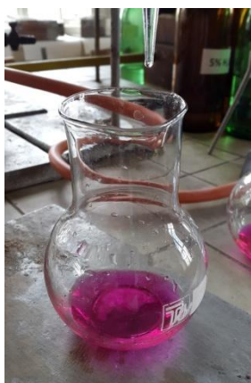
Obr. 45 Důkaz CO 2 v minerální vodě - nalezení bodu ekvivalence
