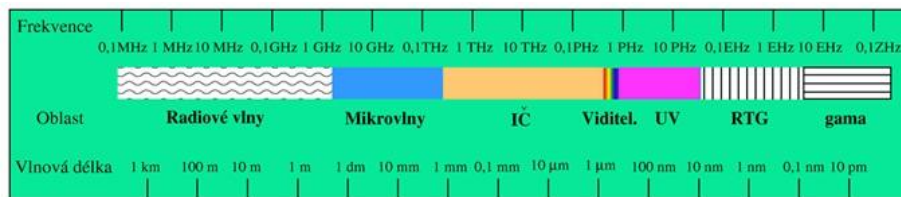
Obr. 3. Typ záření v závislosti na vlnové délce a frekvenci. Maximální spektrální hustota Slunce je 500 nm, tedy ve viditelné části spektra, maximální spektrální hustota odraženého záření od zemského povrchu je ca 10 mm, tedy v oblasti dlouhovlnného infračerveného záření.
