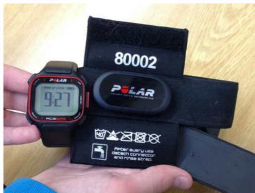
Obr. 4 - Sporttester Polar se zabudovaným GPS snímačem, snímačem tepu a hrudním pásem. Zdroj vlastní. Foto: Lenka Benediktová
