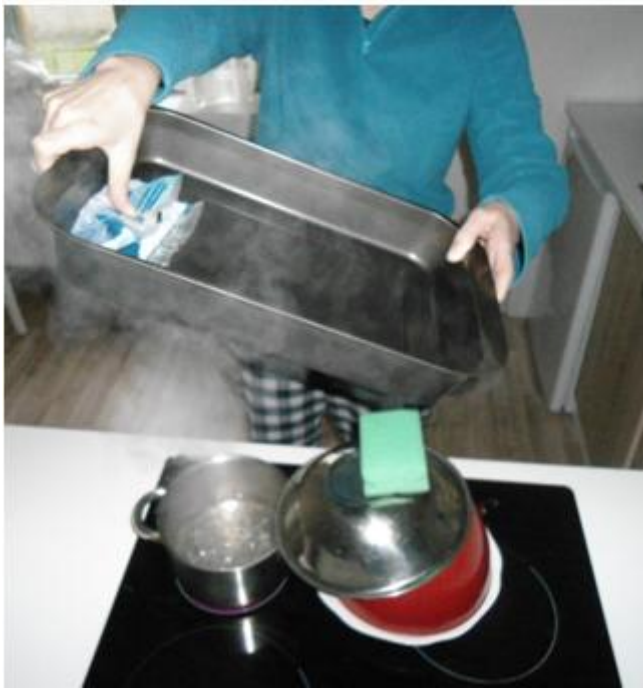
Obrázek 2: Realizace pokusu – Plech je držěn v mírně ukloněné horizontální poloze nad hrncem, ze kterého stoupá vodní pára. V místě, kde je plech ochlazován ledem, dochází ke kondenzaci vodní páry. Kapičky vody stékají po ukloněném plechu a na jeho okraji zkapávají dolů. Dopadávají buď na povrch misky a dále odtékají dolů nebo se vsakují do houby. Odtékající kapky se vrací zpět do hrnce s vroucí vodou. Tím je zjednodušený koloběh vody uzavřen.
