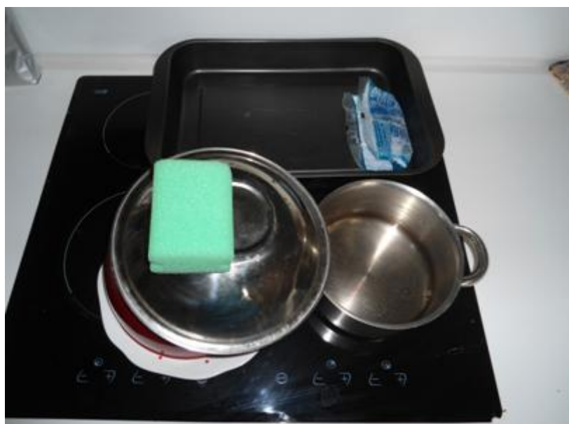
Obrázek 1: pomůcky potřebné k realizaci pokusu – vařič, hrnec s vodou, podložená miska otočená dnem vzhůru, mycí houba a plech s ledem.
