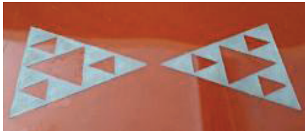
Obrázek II. Bowtie anténa vyrobená technologií Aerosol Jet
