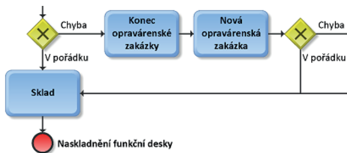
Obrázek IV. Proces linky koncové výroby část D [4]
