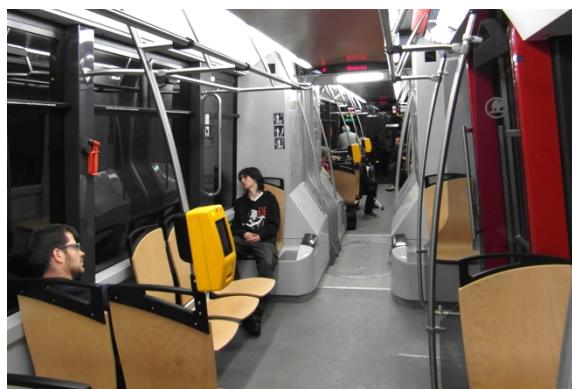
Obrázek 4-46 Uspořádání sedadel v multifunkční části (výjimka invalidní vozík) v tramvaji ŠT 15T Praha[83]
