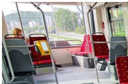
Obrázek 4-17 Uspořádání sedadel v nadpodvozkové části (součást zadní části vozidla) v tramvaji ForCity Plus 29T (Bratislava)[72]
