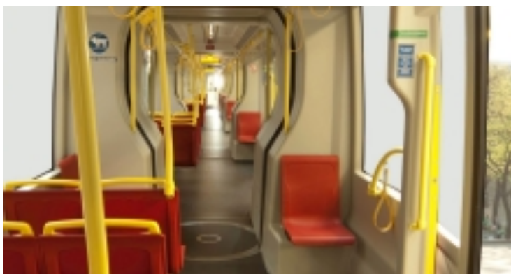
Obrázek 4-62 Uspořádání sedadel v multifunkční části (výjimka invalidní vozík) v tramvaji Siemens ULF (Viedeň)[74]
