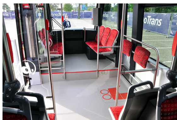
Obrázek 4-34 Uspořádání sedadel v zadní části posledního článku v tramvaji Solaris Tramino Braunschweig[78]
