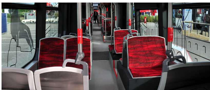
Obrázek 4-3 Uspořádání sedadel v nadpodvozkové části v tramvaji Solaris Tramino Braunschweig s variantou lavic[65]
