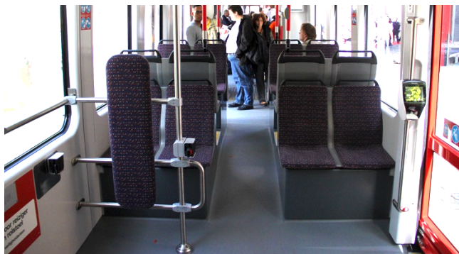
Obrázek 4-58 Uspořádání sedadel v multifunkční části v tramvaji Siemens Avenio (Haag)[88]
