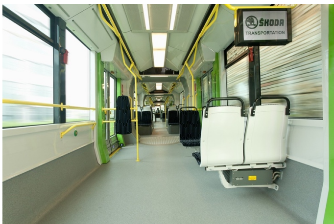
Obrázek 4-50 Schéma uspořádání sedadel v multifunkční části v tramvaji ForCity Classic 26T (Miskolc)
