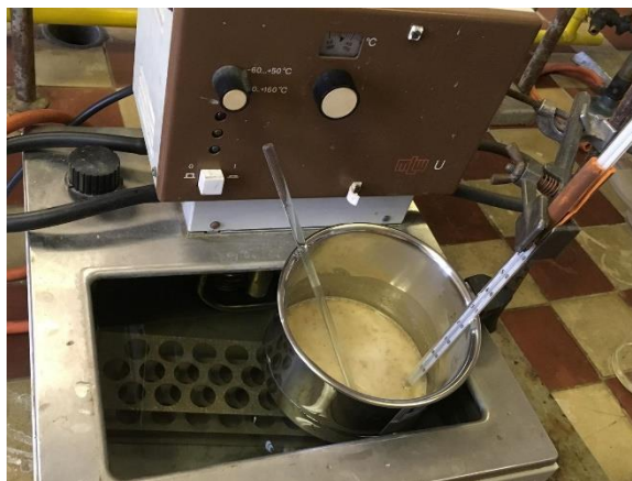
Obrázek 6 Rmutovací lázeň použitá při laboratorním rmutování
