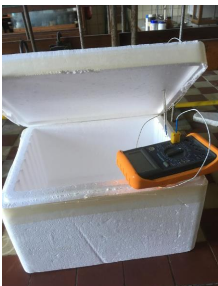
Obrázek 4: klíčící box se zavedenou teplotní sondou
