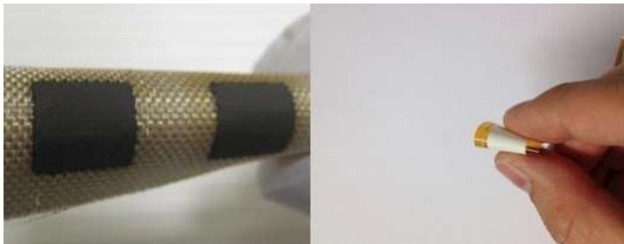
Obr. 1.9 Piezoelektrický flexibilní film na textilií a polymeru (převzato z [28]).
