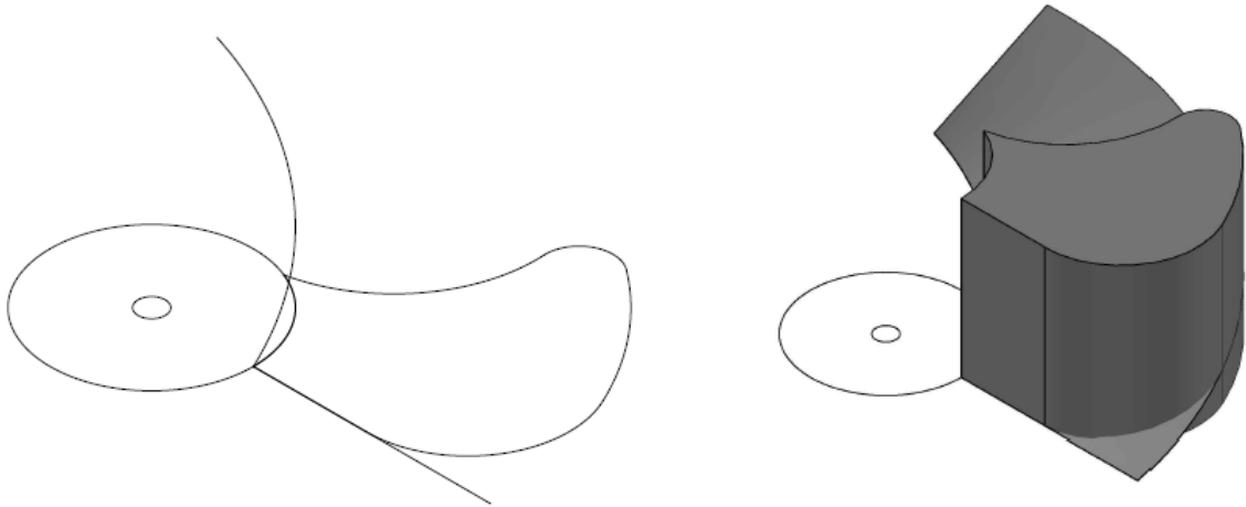
Obr. 5.12: Postup vytvoření lopatky propelerové turbíny
