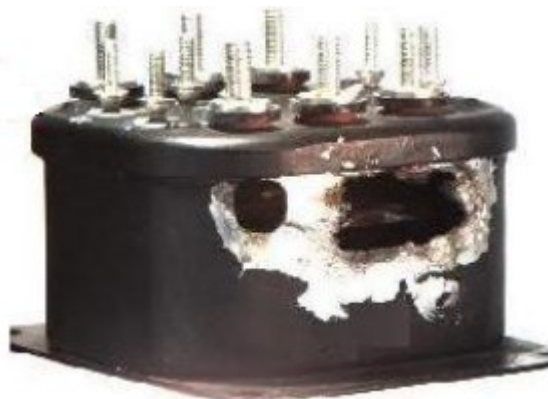
Obr. 8 Selhání relé způsobené vypařením cínových whiskerů (převzato z [8]).
