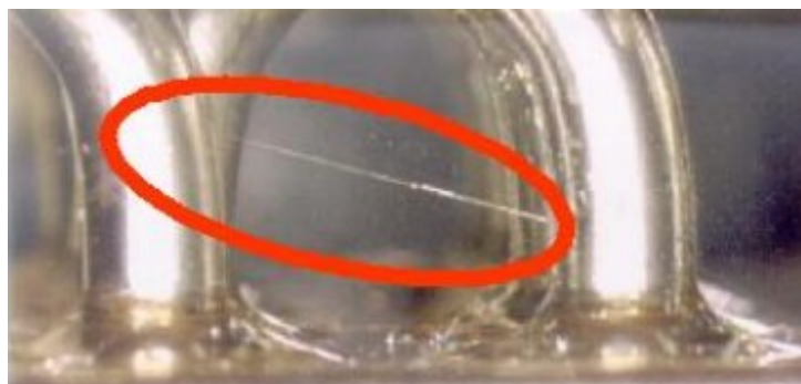
Obr. 7 Rostoucí whisker způsobil zkrat mezi dvěma vývody (převzato z [8]).
