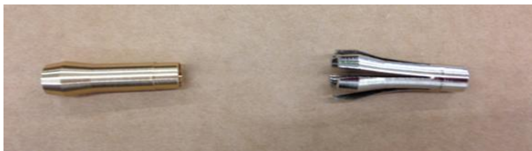
Obr. 3.4 Zleva: kleštětec vyrobený na soustruhu a kleštětec poniklovaný a rozřezaný
