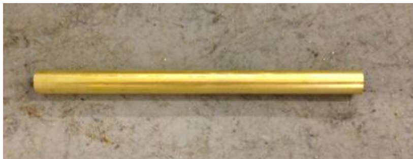
Obr. 3.3 Nařezaná a odjehlená trubička
