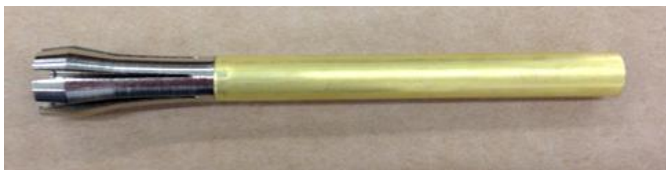
Obr. 3.5 Kleština nasazená na trubce před zalisováním
