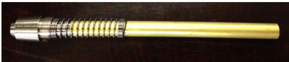
Obr. 3.6 Zalisovaná pružina na trubce
