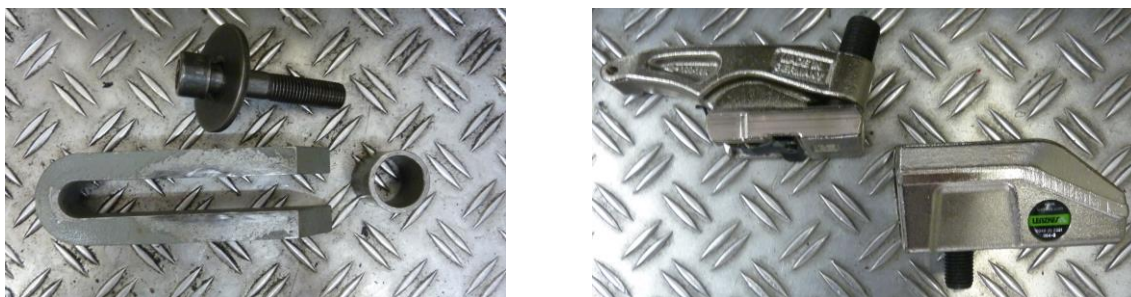
Obr. 4.8. Rychlo upínky (vpravo) a šroubovací klasické upínky (vlevo)
