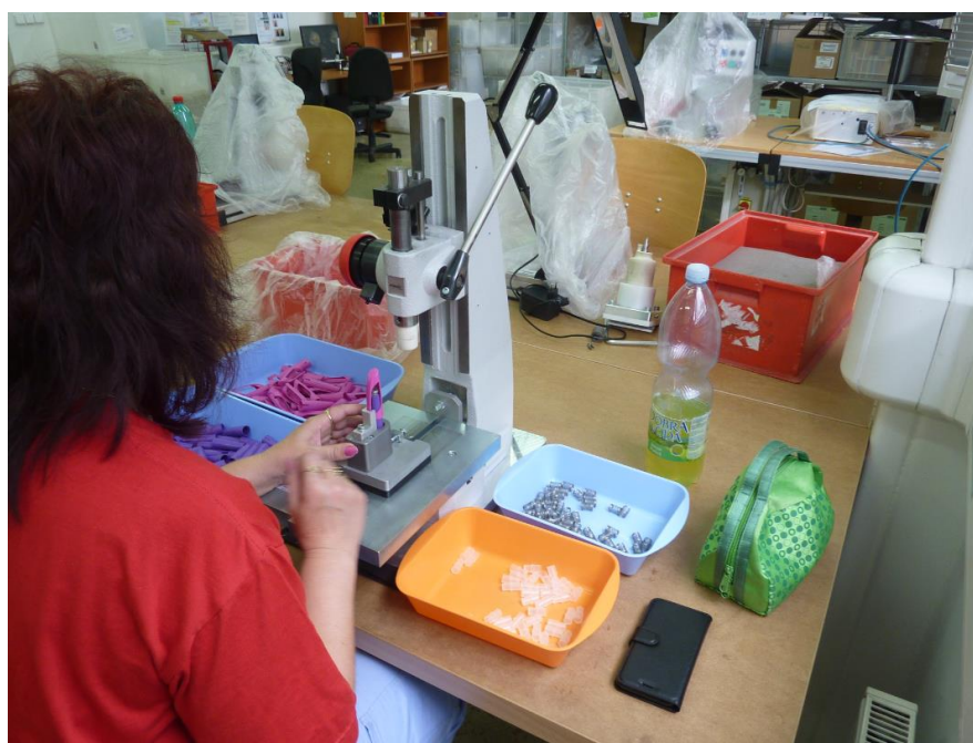
Obr. 4.1. Ruční montáž plastového víčka plnicího pera
