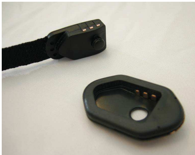
Obr. 2.15 – Zástrčkový konektor od společnosti Ohmatex, převzato z [35]
