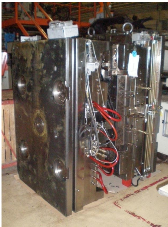
Obr. 2.4: Forma na výrobu plastového dílu
